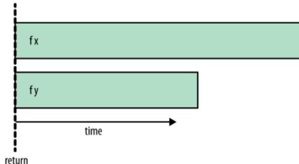
Hier passiert das `return` sofort. Der Rest des Programmes läuft weiter, während  $(f\ x)$  und  $(f\ y)$  (parallel) ausgewertet werden.
